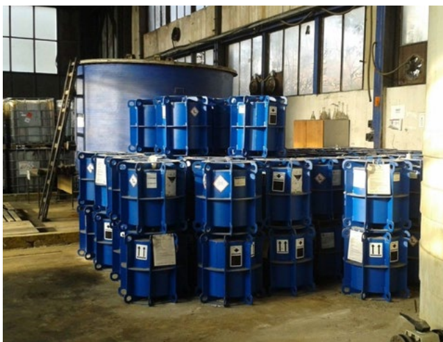
Skladování odpadní kovové rtuti v rozporu s požadavky platné legislativy
