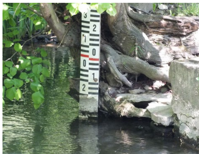
Umístění vodočetné latě pro sledování minimálního zůstatkového průtoku
