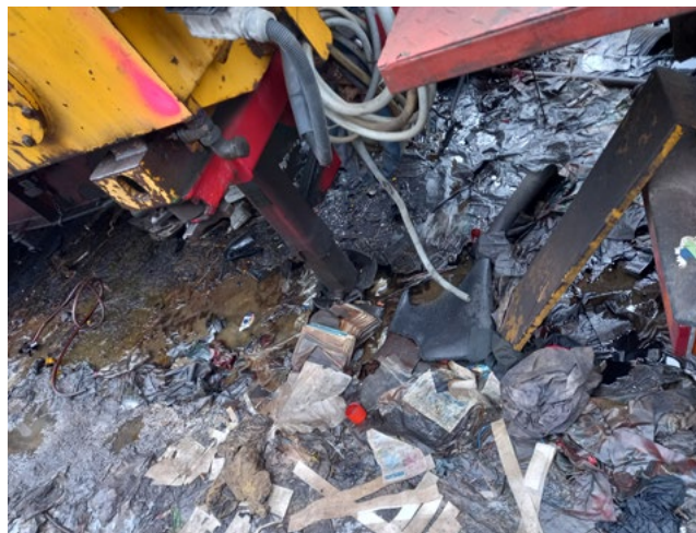
Skladování závadných látek na vodohospodářsky nezajištěné ploše
