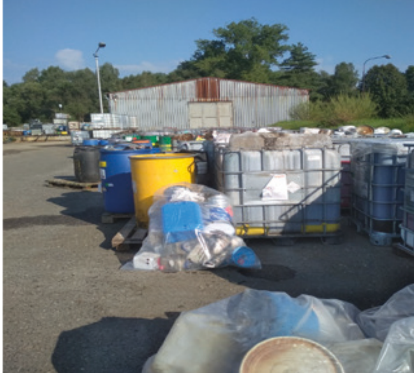
Skladování nebezpečných odpadů mimo vyhrazená místa
