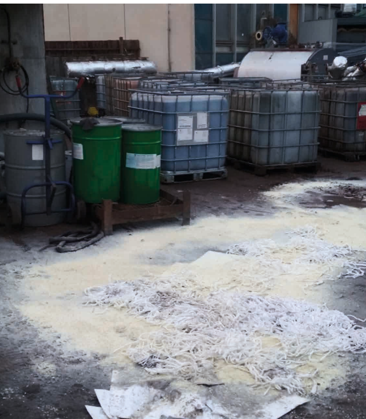
Nezabezpečení IBC kontejnerů v blízkosti dešťové vpusti
