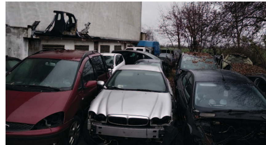
Skladování vozidel s ukončenou životností na vodohospodářsky nebezpečné ploše
