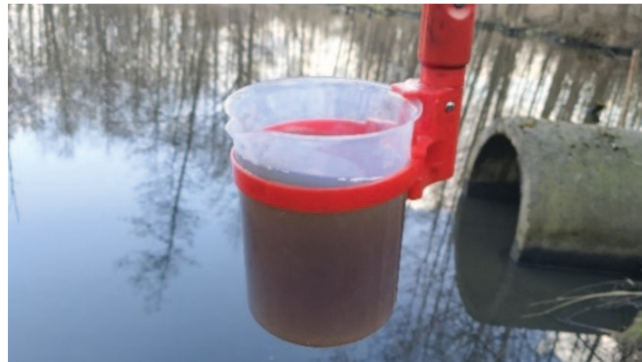
Vzorek vypouštěné odpadní vody z ČOV
