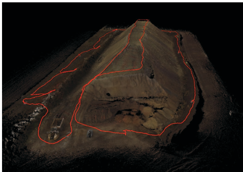
Mračno bodů a trajektorie FARO Orbis (skener s 32 lidarovými kanály s dosahem až 120 m a rychlostí skenování 640 000 bodů)
