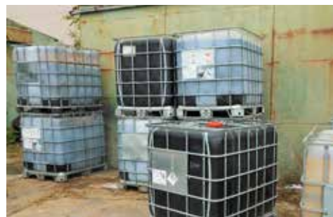
Znečištěné IBC kontejnery umístěné na vodohospodářsky nezabezpečené ploše
