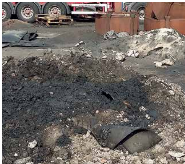
Nezabezpečený odpad - směs odpadního slévarenského písku a oleje ve slévárně šedé litiny (OI Brno)
